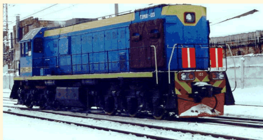
Фото №121. Модернизированный маневровый тепловоз нового поколения серии «ТЭМ-18», выпускаемый Брянским тепловозостроительным заводом с 1992г.
