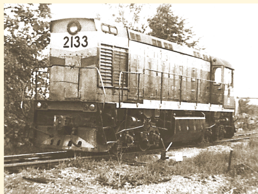
Фото №80. Фактически приход на завод стальных коней серии «ТГМ-6» и предопределил печальную участь оставшихся в цехе паровозов. Внешнее сходство этого локомотива с «ТЭМ-2» (за исключением, конечно, тележек) для несведущего было очень похожим, но главное различие состояло как раз внутри: передача усилий на колёсные пары у «ТГМ-6» была гидромеханическая, в то время как у «ТЭМ-2» - электромеханическая. Фотография сделана в середине 90-ых годов.
