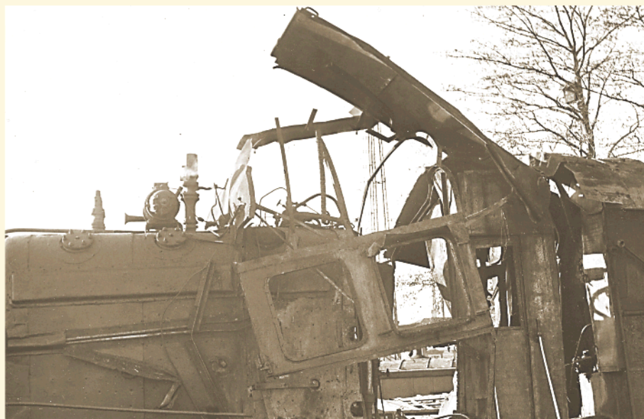
Фото №140. Кабина паровоза «Э» после взрыва в 1957г.
