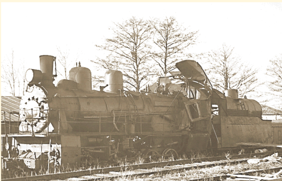
Фото №72. Увы, но кроме непосредственной тяжелой работы для машинистов и кочегаров, стальные кони иногда могли быть и угрозой для их жизни при технической неисправности, неправильном обслуживании и грубейшем нарушении техники безопасности во время работы. На снимке: паровоз серии «Э» на тупиковых путях после взрыва. Конец 50-ых.
