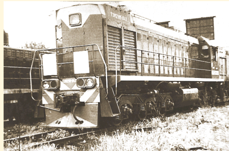
Фото №77. Тепловозы Брянского машиностроительного завода «ТЭМ-2» появились впервые в железнодорожном цеху в 1972г. и с годами их количество постоянно пополнялось. Мощные и относительно неприхотливые в обслуживании, даже сейчас, спустя четыре десятилетия, эти локомотивы исправно работают на маневрах.
