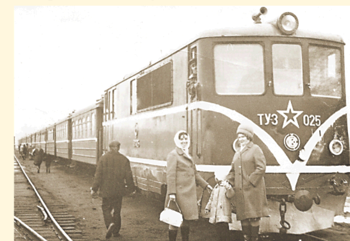
Фото №71. Узкоколейный тепловоз «ТУ-3», поступивший в работу на железные дороги Выксы в 1958. Этот локомотив работал с пассажирскими поездами и любовно получил от перевозимых им пассажиров прозвище «тушка» - как правило, в народе, такого рода названия являются признаком большой симпатии и доверия. Фото начала 60-ых годов.
