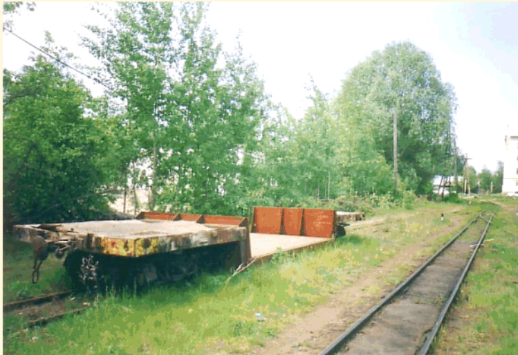
Фото № 110. Вместе со списанными узкоколейными локомотивами канули в лету и вагоны у\к. На снимке: специализированная платформа, использовавшаяся для перевозки грузов при обслуживании чугунолитейного цеха. Фотография сделана осенью 2003 г.
