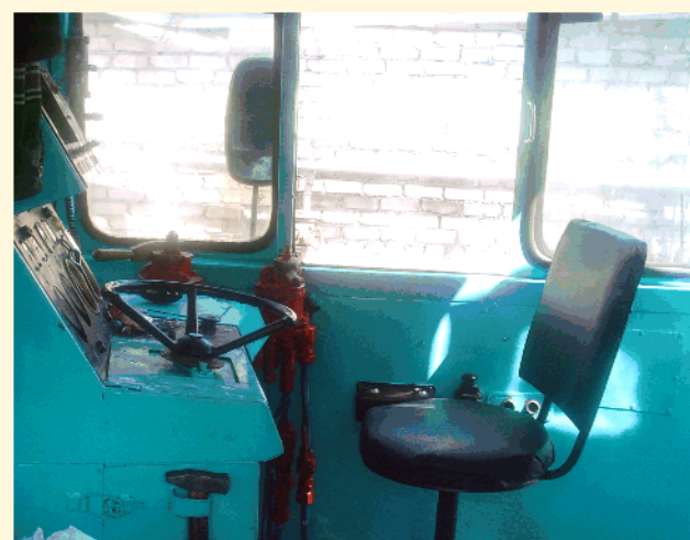
Фото №96. Пульт управления машиниста тепловоза «ТГМ-4Б». Снимок сделан в июле 2005г.
