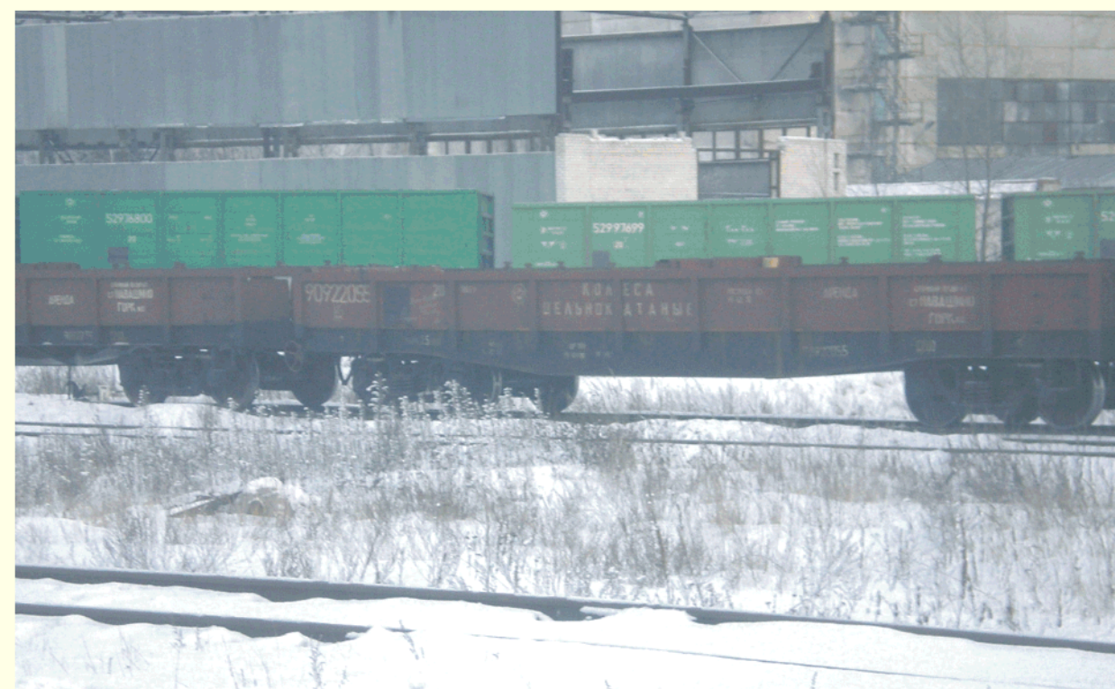
Фото № 178. Для перевозки знаменитых выксунских колёс на сети железных дорог используются не только обычные полувагоны, но и специальные платформы, продукцию в которые очень удобно и легко разгружать. На фотографии: железнодорожные платформы для продукции КПК на станции «Прокат». Снимок датирован январём 2008г.
